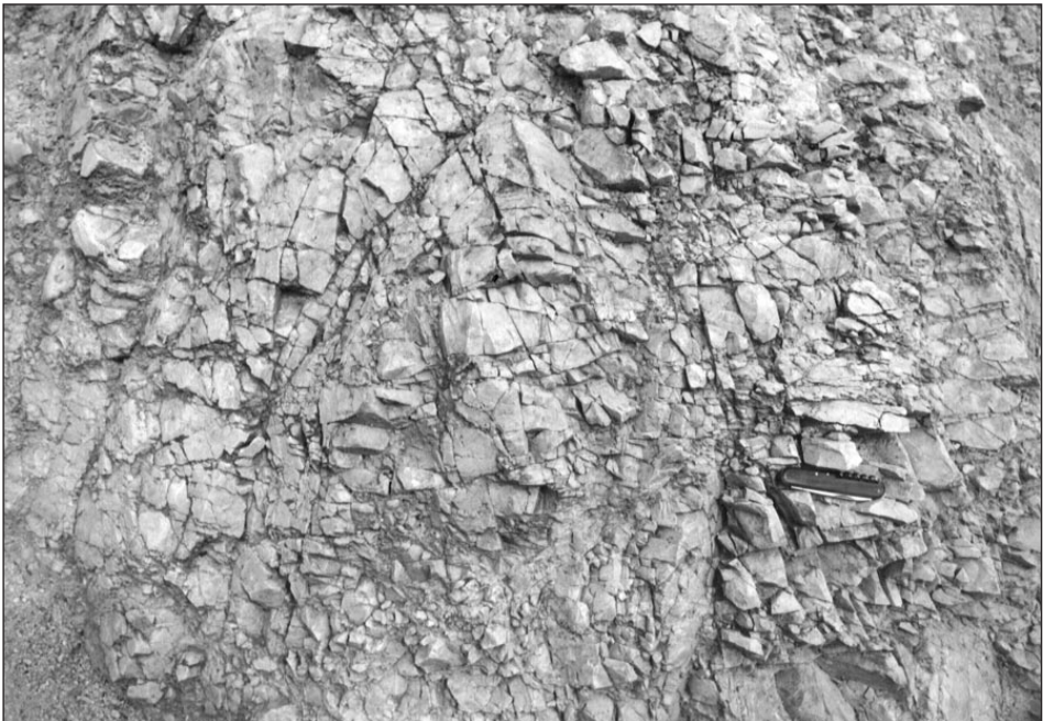
Abb. 6. „Dichte Zerklüftung“ in allochthoner, vergriester Massenkalkscholle. Steinbruch auf der Anhöhe zwischen Iggenhausen und Katzenstein. (Taschenmesser als Maßstab: 9 cm lang.)
